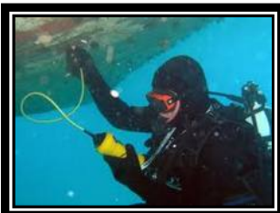
UT Meter Hull Survey for CLASS
